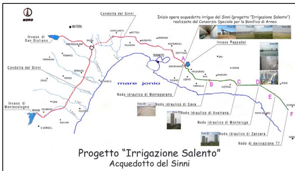
Figura 27. Schema opere idrauliche realizzate dal Consorzio di Arneo relative al sistema irriguo "Irrigazione Salento"
